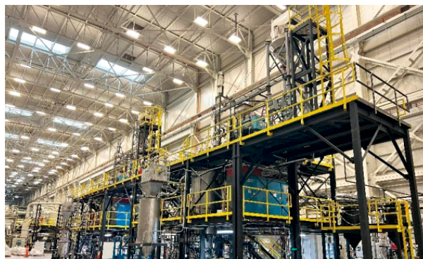
ノボニックス社の連続黒鉛化炉(2024年2月時点)
