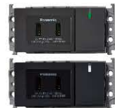
埋入式USB智能快速 充電插座2孔·開關組合 (附燈光開關C) WTGF107216H (灰色) WTGF107216MB (霧黑) (輸入 AC 110 V / 220 V 0.4 A 60 Hz) (輸出 DC 5 V 合計3 A) (單孔輸出最大DC 5 V / 2.4 A) (單孔最高輸出12 W) (雙孔合計輸出15 W) (燈光開關 15 A 110 V AC)
