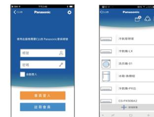
步驟1: 按下新增家電後，請先檢查LED燈是否為閃爍狀態。若為否，請按壓無線控制器下方按鈕7秒後放開，使LED燈為閃爍狀態。若LED燈為閃爍狀態，則連線Panasonic Smart-XXXX進行連線完成連線後，手動返回APP頁面進行後續連線步驟。
