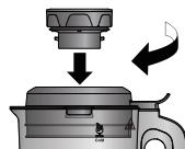
4. 将玻璃杯底部的“▽”图标对准机身上的“△”图标放入机身底座。
