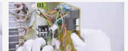
ดึง PCB หลุดออกโดยไม่ต้องใช้สกรูทำให้ง่ายต่อการถอด PCB
