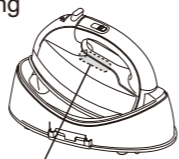
Hệ thống chống tích vôi (Trong bình chứa nước)
