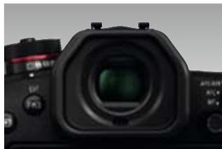
Der elektronische Sucher der LUMIX G9 bietet mit ca. 1,66x/0,83x (35 mm KB) eine überragende Vergrößerung. Je nach Aufnahmesituation lässt sich die Vergrößerung durch einfachen Knopfdruck am Sucher auch auf 0,7x, 0,77x und 0,83x einstellen.
